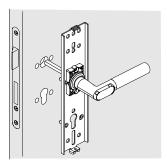
▶ Bohrschablone auf den Vierkantstift stecken, waagrecht ausrichten und Lochmarkierungen ankörnen.
