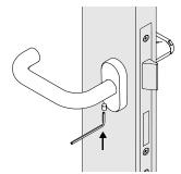
Bei geöffneter Tür die Funktionsfähigkeit und Leichtgängigkeit des Drückers prüfen. Im Auslieferungszustand ist der Türdrücker bereits eingekuppelt. Im eingekuppelten Zustand muss beim Herunterdrücken der Klinke die Falle des Schlosses vollständig in den Schlosskasten eintauchen.
