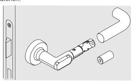
Verbrauchte Batterie entnehmen und neue Batterie einsetzen, dabei auf die Polarität achten. Der Minuspol der Batterie zeigt in Richtung der Griffhülse. Beim Einlegen der Batterien muss sich der Türdrücker in der horizontalen Grundstellung befinden, damit der Lagesensor richtig eingestellt und die korrekte Funktion gewährleistet werden kann.  Falls der Türdrücker im Außenbereich eingesetzt wird, den Dichtungsring des Türdrückers wechseln (siehe Kapitel 7.2.2 Dichtungsring wechseln, Seite 38).
