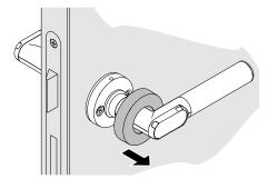
Befestigungsschrauben lösen. Inneren elektronischen Türdrücker vom Vierkantstift abziehen. Äußeren elektronischen Türdrücker aus dem Schloss herausziehen.
