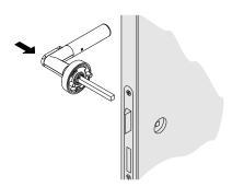
▶ Bohrschablone auf den Vierkantstift stecken, waagrecht ausrichten und Lochmarkierungen ankörnen.
