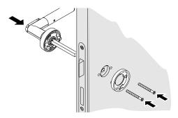
Mechanischen Türdrücker aufstecken, Türdrücker dabei waagrecht halten. Bei nach rechts zeigenden Türgriffen Rosette nach links spannen, über die Drückeraufnahme führen und Bajonettverschluss einrasten lassen. Entsprechend bei nach links zeigenden Türgriffen Rosette nach rechts spannen.
