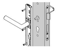
Schildabdeckung an beiden Türdrückern auf die Grundplatte aufsetzen und Sicherungsschraube an der Unterseite des Schilds herausschrauben, so dass das Schild fest sitzt.
