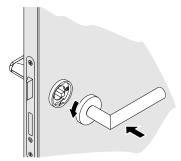
Sicherungsschraube an der Unterseite des Griffs einschrauben und fest anziehen.
