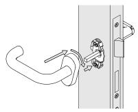
Sicherungsschraube an der Unterseite des Griffs einschrauben und fest anziehen.
