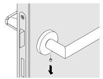
▶ Den Bajonettverschluss lösen. Dazu bei nach rechts zeigenden Türgriffen die Rosette nach links spannen und den mechanischen Türdrücker vom Vierkantstift abziehen. Bei nach links zeigenden Türgriffen die Rosette entsprechend nach rechts spannen.
