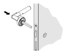
Bohrschablone auf den Vierkantstift stecken, waagrecht ausrichten und Lochmarkierungen ankörnen.
